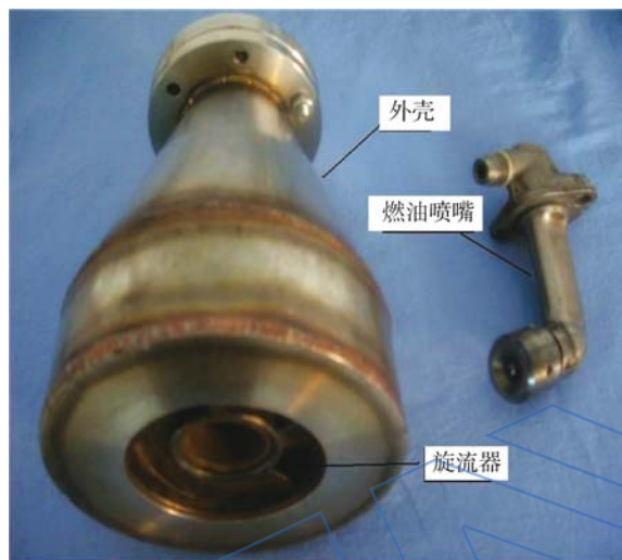
(d) 离心喷嘴及其旋流器实物照片
